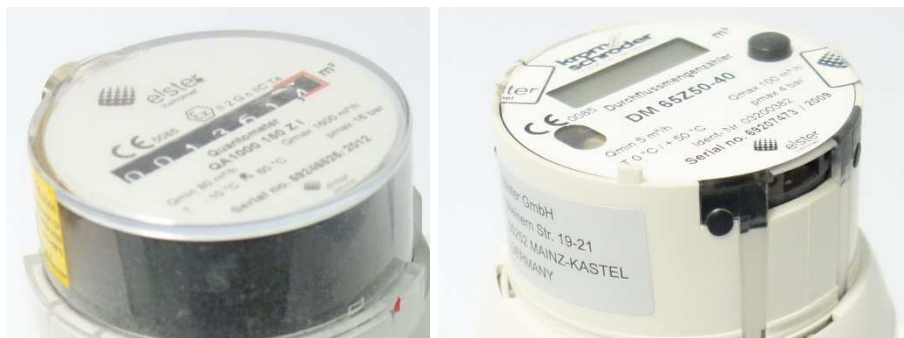
Fig. 2 | Cabezales totalizadores – izquierda: mecánico (QA), derecha: electrónico (QAe)
